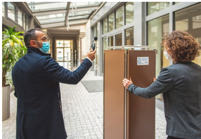
Das Betriebliche Gesundheitsmanagement führt Schallpegelmessungen zur Verbesserung der Arbeitsbedingungen für das Kantenpersonal durch.
