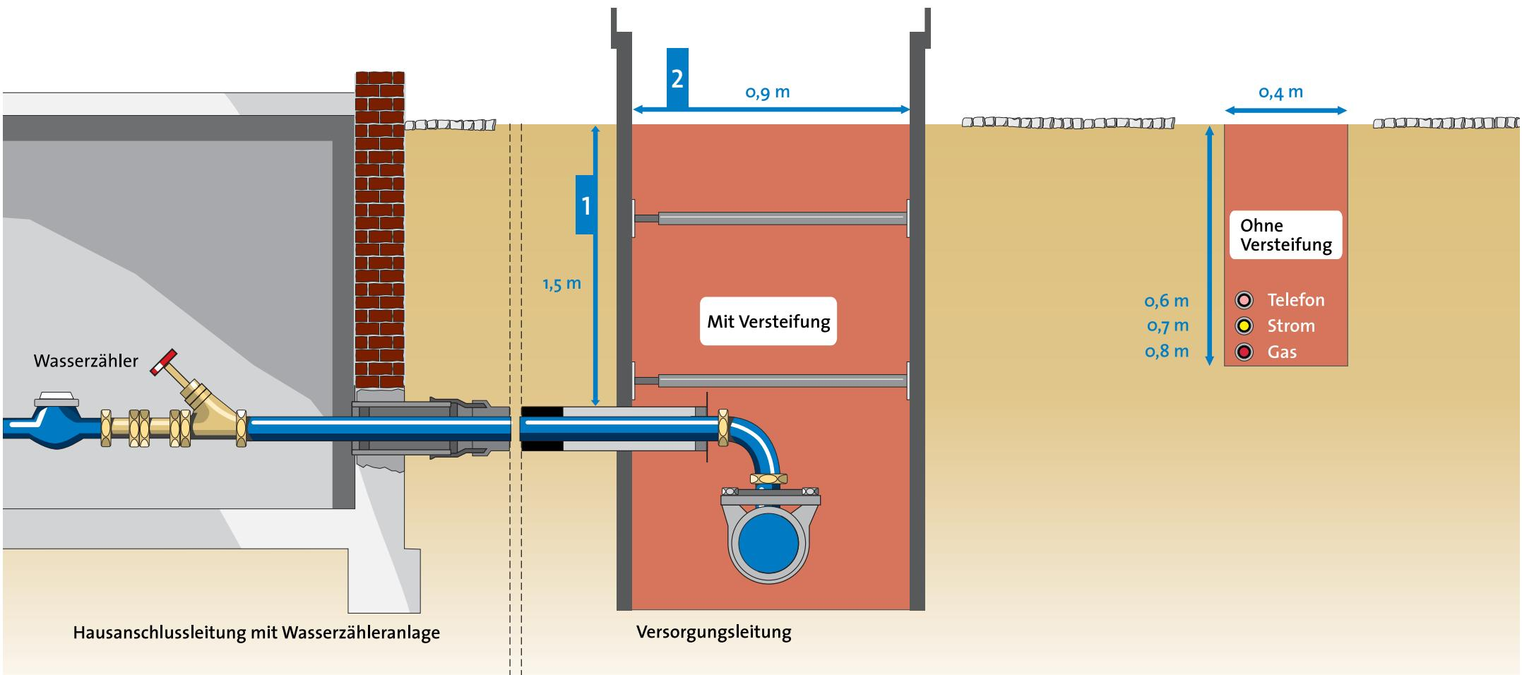
Vergleich der Grabenquerschnitte für Strom, Gas und Telefon (rechts) sowie Trinkwasser (Mitte): vierfach höherer Erdaushub notwendig.
