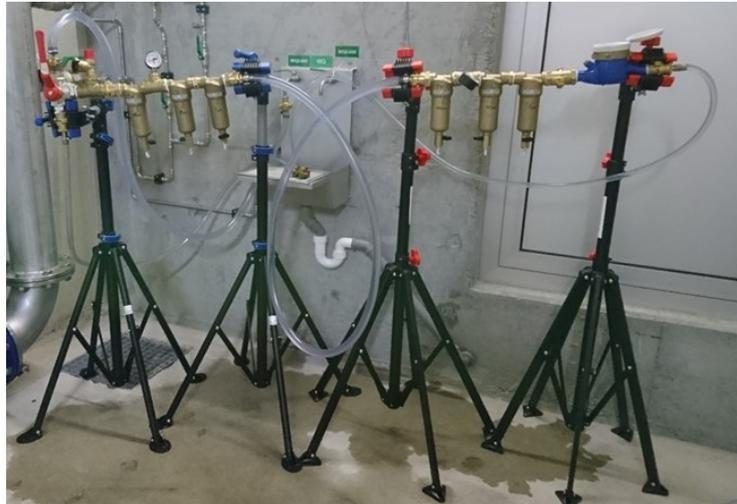
Abbildung 15: Trinkwasserprobenahme mit fraktionierender Filterkaskade (links) und Prozessblindwert (rechts)
