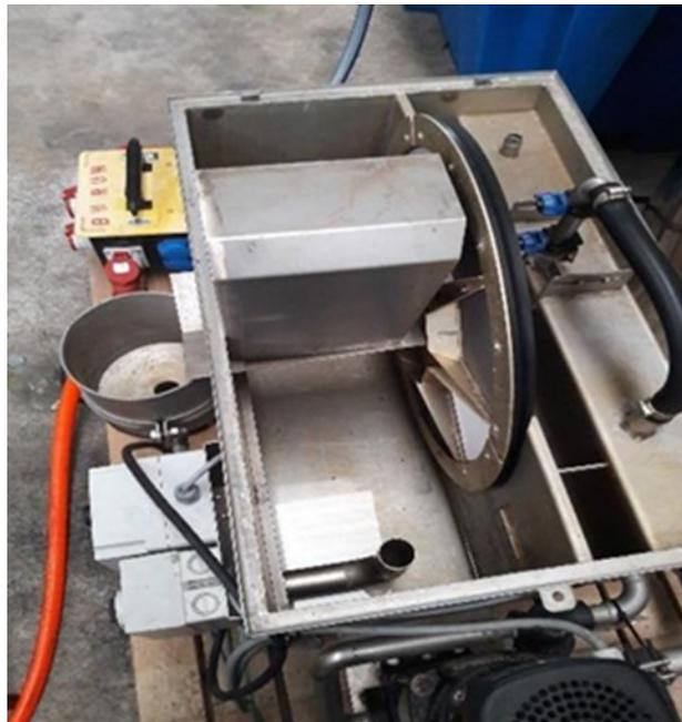
Abbildung 63: HYDROTECH-Anlage mit abgenommenem Deckel, links vom Filtrerrad: Zulaufseite, rechts vom Filtrerrad: Filtratseite mit Rückspüldüsen
