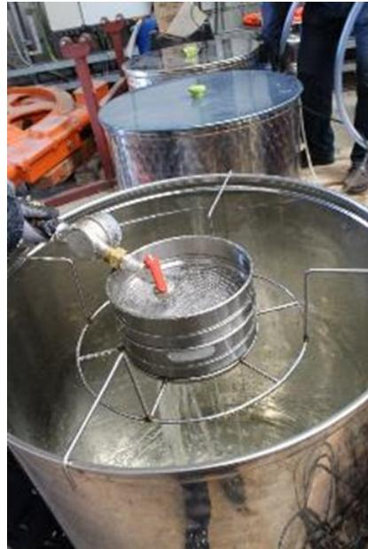
Abbildung 3: Siebturm für die fraktionierte Filtration mit großen Porenweiten
