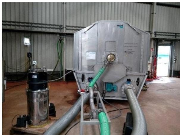
Abbildung 62: INVENT-Anlage in der Versuchshalle Ruhleben: Filtratleitung unten links, Notüberlauf unten rechts und Spülwasserleitung in der Mitte (grüner Schlauch)
