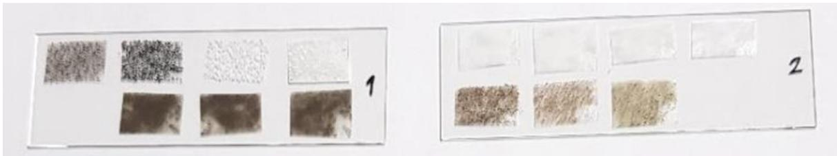
Abbildung 29: Beispielfoto von fixierten Partikeln auf doppelseitigem und leitfähigem Klebeband
