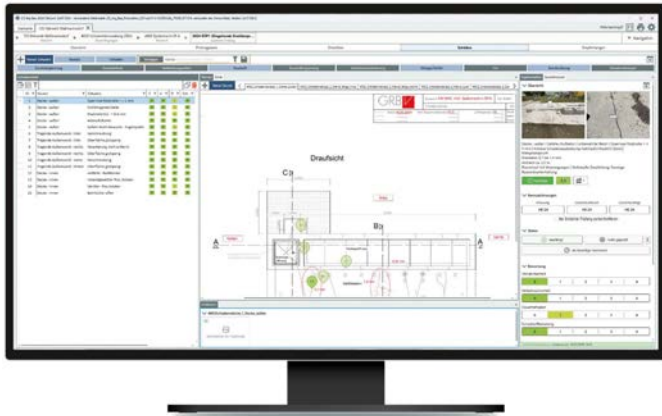
Bild 10 Spülschacht SP4: Schadensskizze der Schachtdecke mit Verortung der Schäden und Schadensbilder Rinsing shaft SP4: shaft ceiling damage localization and pictures
