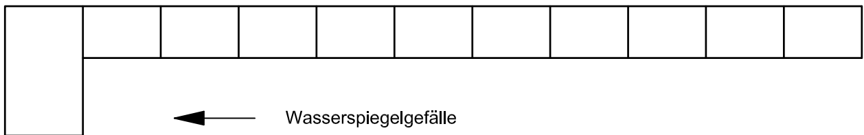
Bild 5 – Kastenrinne ohne Gefälle in der Sohle (Schematische Darstellung)
