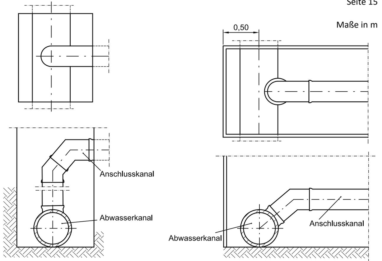
**Bild 5 – Baugruben für Anbohrungen mit Aufständering**
