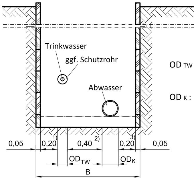
OD<sub>TW</sub> : Äußerer Rohrschaftdurchmesser für die Trinkwasserhausanschlussleitung/ das Schutzrohr
