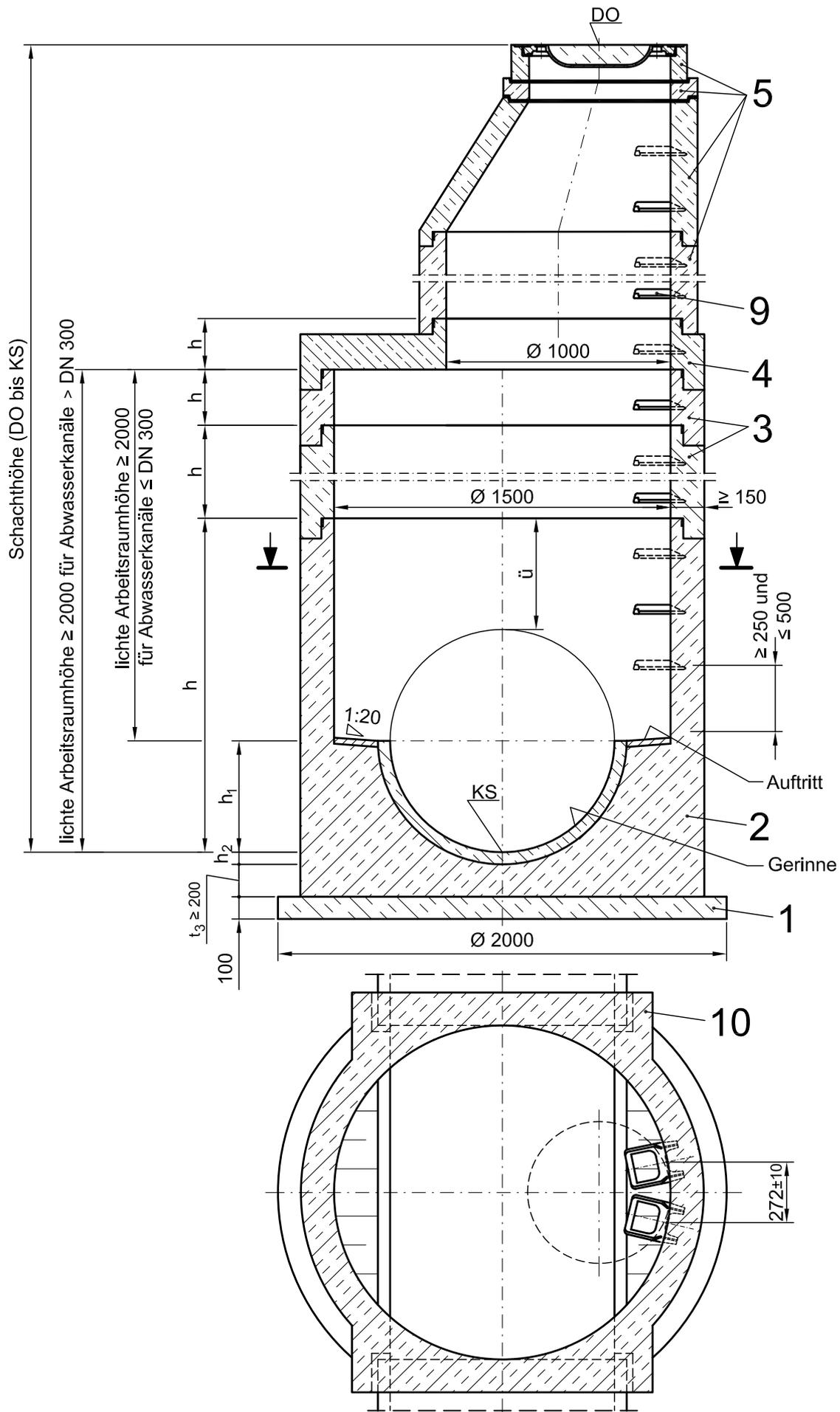
**Bild 1 – Einsteigschacht DN 1500 aus Beton- und Stahlbetonfertigteilen nach DIN V 4034-1
