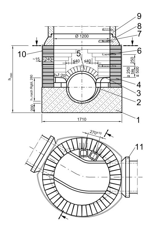
Bild 1 – Einsteigschacht DN 1200 mit Schachtunterteil aus Mauerwerk nach DIN 4034-10 und Regelblatt 100 – dargestellt: Abwasserkanal DN 600
