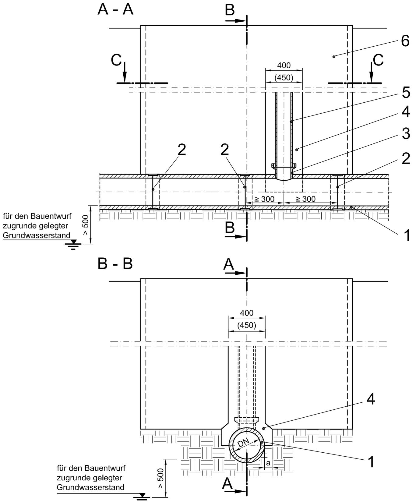
Für Abwasserkanäle  $\leq$  DN 500:  $a = \frac{1}{4}$  DN in mm, mindestens 100 mm
