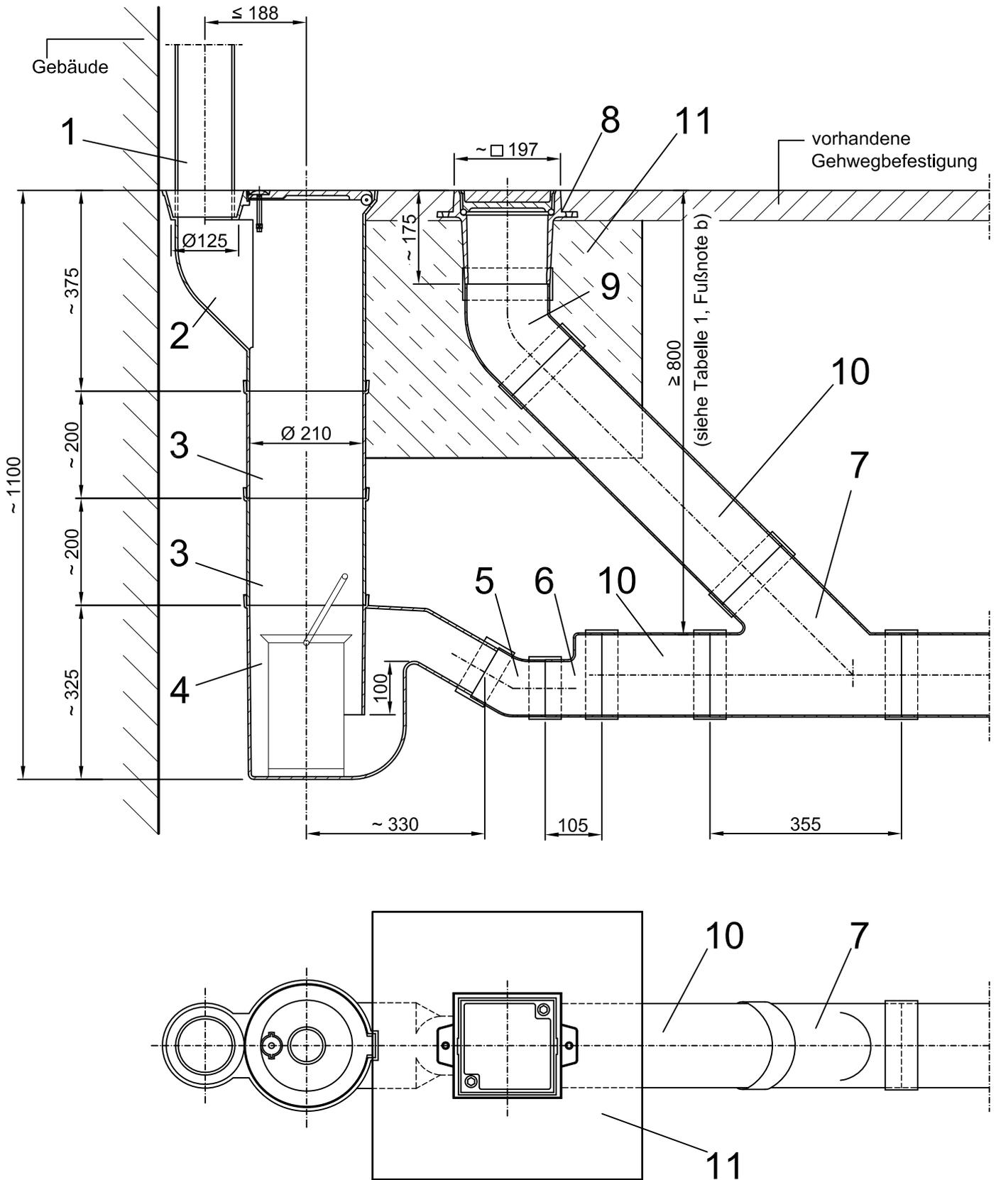
**Bild 1 – Regenwasserfallleitungen, Erneuerung von Abläufen mit Geruchsverschluss**
