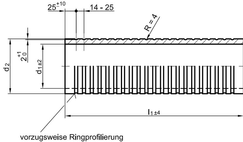
**Bild 1 – Futterrohr aus zementgebundenem Material (FZ-Futterrohr)**
