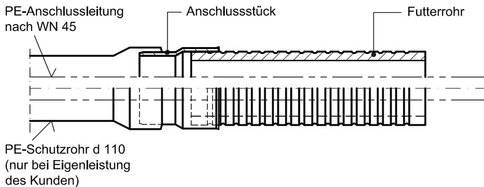
**Bild 2 – FZ-Futterrohr mit Anschlussstück KGUG DN 100 zur Aufnahme des PE-Schutzrohres d 110**
