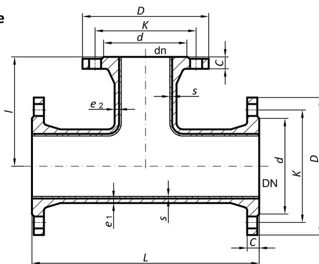
**Bild 1 – Flansch-T-Stück DIN EN 545**
